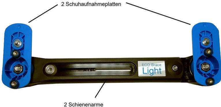
Die 2 Schienenarme liegen übereinander und sind mit 2 Schrauben miteinander verbunden. Zur Veränderung der Schienenlänge werden die Schrauben mit den beiliegenden Schlüsseln gelockert, die Schienenarme auf die gewünschte Länge verschoben und die Schrauben wieder angezogen.
